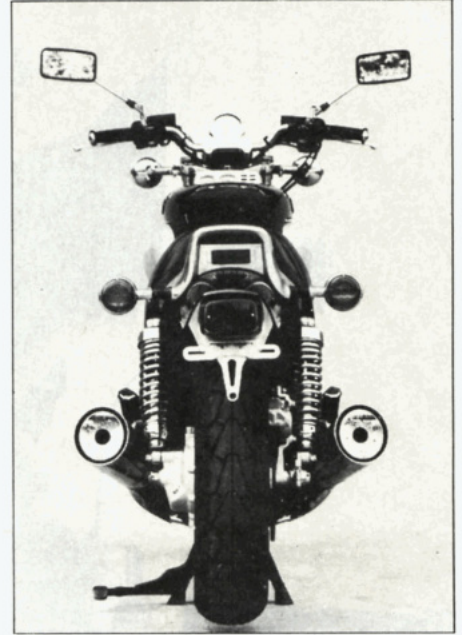
Moto originale e piuttosto barocca, la V-Max evidenzia nelle tre viste ortogonali alcune peculiarità: come la profonda differenza di sezione tra i due pneumatici, il piccolo proiettore che non sporge dagli steli della forcella, i silenziatori tagliati corti e molto divaricati. Dall'alto, pregevole la snellezza della zona centrale (tra sella e guscio anteriore) ed evidente la scomodità della porzione posteriore del sellone; la sagomatura è invertita rispetto alle necessità del passeggero, e l'imbottitura è soltanto teorica.
